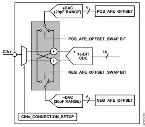
Figure 23. Analog Front-End Offset Control
