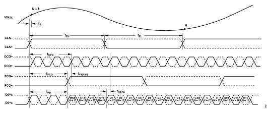
Figure 6. Wordwise DDR, One-Lane, 1× Frame, 16-Bit Output Mode
