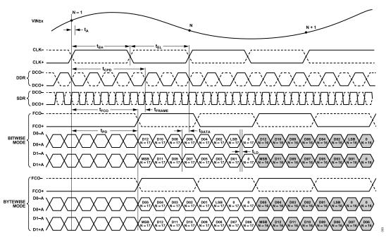
Figure 2. 16-Bit DDR/SDR, Two-Lane, 1× Frame Mode (Default)
