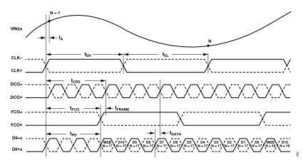
Figure 7. Wordwise DDR, One-Lane, 1× Frame, 12-Bit Output Mode
