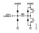
Figure 23. Equivalent LNA Output Circuit
