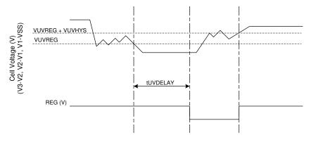
Figure 8-2. REG Output Timing
