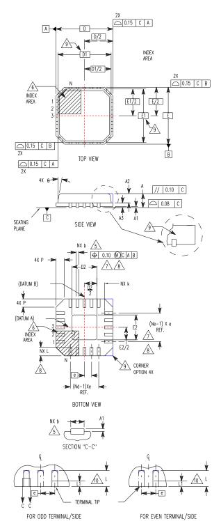
L20.5x5 20 LEAD QUAD FLAT NO-LEAD PLASTIC PACKAGE
