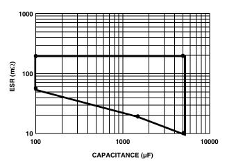
FIGURE 11. VOUT1 OUTPUT CAPACITOR SELECTION
