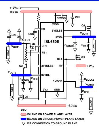
FIGURE 12. PRINTED CIRCUIT BOARD ISLANDS
