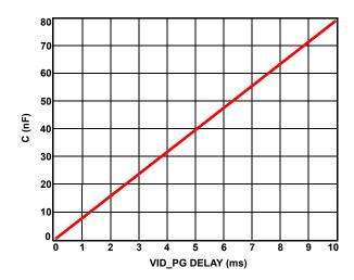
FIGURE 10. VID\_PG DELAY DEPENDENCE ON VID CT CAPACITOR
