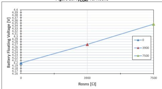
Figure 26. V<sub>FLOAT</sub> vs. Rosns
