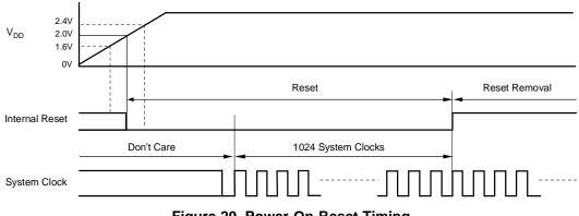
Figure 20. Power-On-Reset Timing
