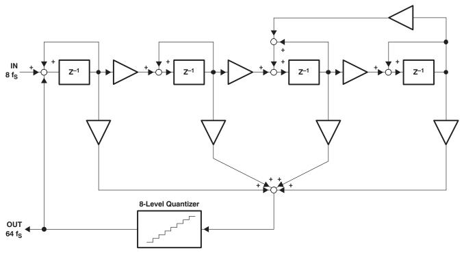
Figure 30. Eight-Level Delta-Sigma Modulator
