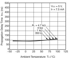
PROPAGATION DELAY TIME vs. AMBIENT TEMPERATURE
